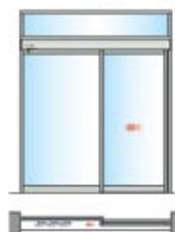
Porte simple sans partie fixe (la figure montre une ouverture à gauche)
